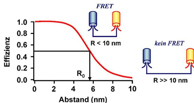
Abb.5 Die rote Kurve zeigt den Verlauf der Abstandsabhängigkeit der Transfereffizienz  $E$  für einen Förster-Radius  $R_0$  um die 6 nm. Im Bereich um den Försterradius kann der Abstand besonders genau bestimmt werden, da hier die Steigung der Kurve betragsmäßig am größten ist.
