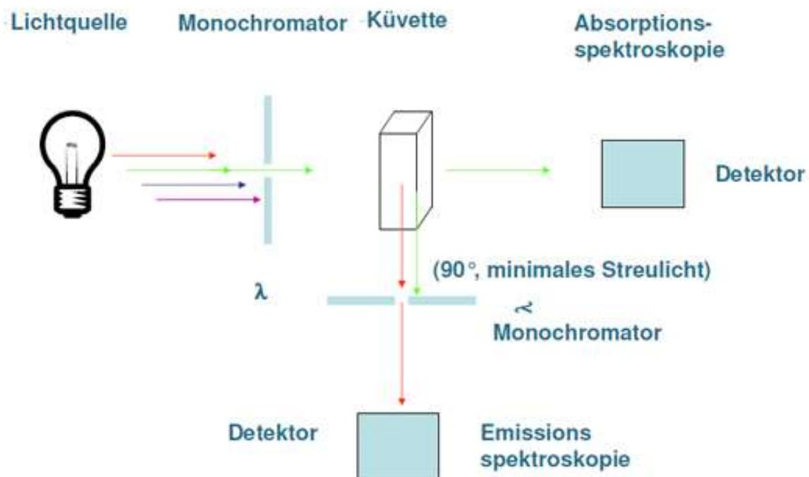
Abb. 2 Skizzierter Aufbau eines Fluoreszenzspektrometers
